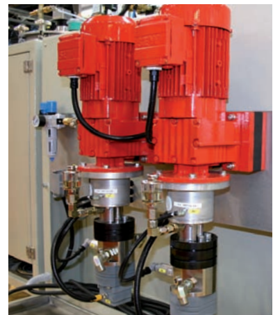
定量泵集成流量计, 用于双组份或多组份混合系统
