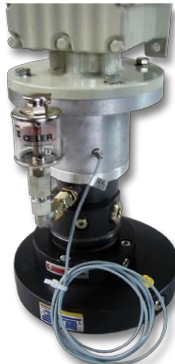
Groupe motopompe pour vide-fût monté sur plateau suiveur
